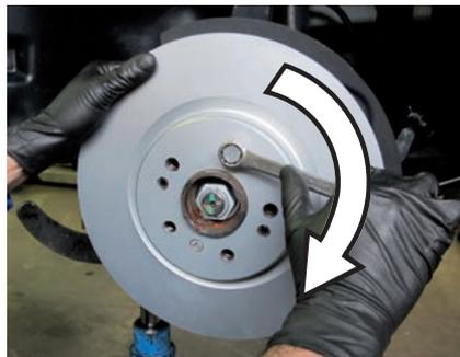
14. **Rieseguire il controllo di sbandamento** una volta montato il disco freno per assicurarsi che giri correttamente senza oscillazioni anomale; l'oscillazione complessiva nell'arco di un giro completo non dovrebbe mai superare 0.1 mm
