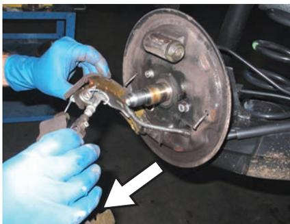
11. **Rimuovere il cavo del freno a mano**, se necessario aiutarsi con un attrezzo, ma fare attenzione a non danneggiare il cavo durante la sua rimozione
