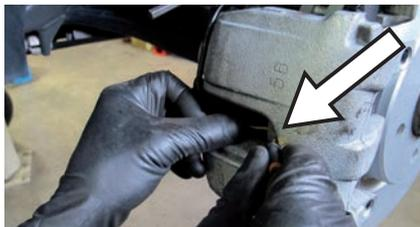
19. **Avvitare le viti della pinza;** anche in questo caso è importante **serrare a coppia controllata** utilizzando una chiave dinamometrica, rispettando le prescrizioni di serraggio raccomandate della casa costruttrice
