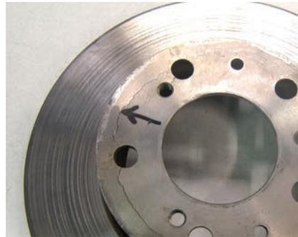
**Temperatura di esercizio eccessiva/ utilizzo intensivo:** Il disco presenta cricche sulla fascia frenante dovuta a fatica termica.
