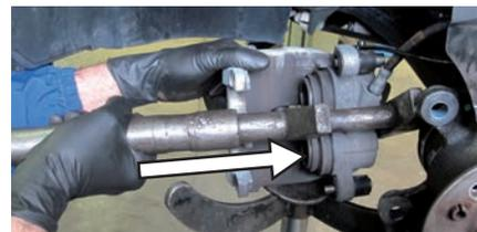
12. **Montare** sul mozzo con la superficie già pulita il **nuovo disco freno**. Se il disco è fornito con il trattamento DSP (**D**isc **S**urface **P**rotection) non serve eliminare il trattamento dalle fasce frenanti, in caso contrario si raccomanda una pulizia delle fasce con un prodotto detergente per rimuovere il protettivo
