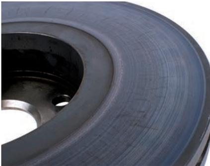
**Serraggio viti errato:** Formazione di cricche sul piano in contatto con il mozzo dovuta all'errata sequenza e coppia di serraggio delle viti. L'errato serraggio delle viti causa una deformazione del piano di fissaggio anche se quest'ultimo non presenta cricche visibili.
