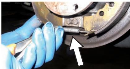
6. **Rimuovere entrambe le clip metalliche ai lati delle ganasce** facendo attenzione a non deformarle, andranno riutilizzate
