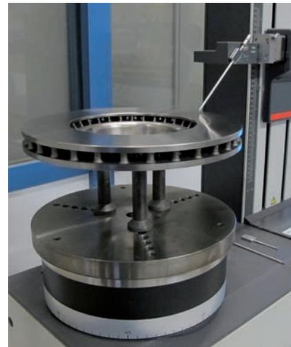
*Strumentazione di verifica disco in sala metrologica*
