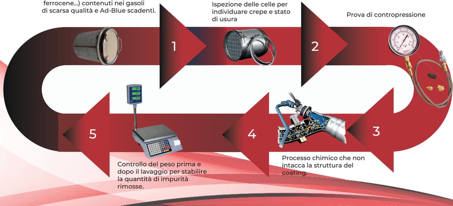
Controllo del peso prima e dopo il lavaggio per stabilire la quantità di impurità rimosse.
