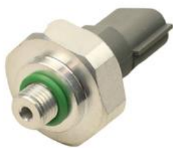
SENSORE PRESSIONE CLIMATIZZATORE RENAULT MASTER 10> 2.3 113/213/223/323 16> 3 -PIN
